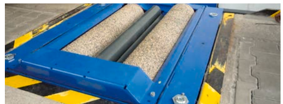
Jeu de rouleaux bas spécialement adapté pour tests de freinage mobiles.
