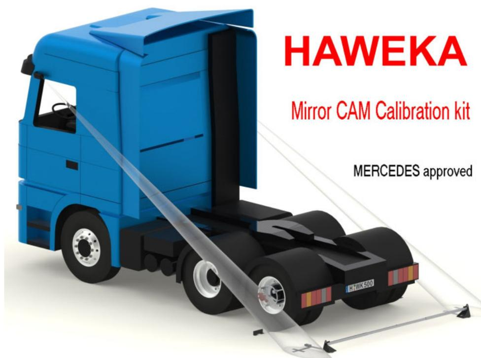
Le système fonctionne rapidement et de manière extrêmement précise grâce à l'assistance de lasers et de pinces de roue sur l'essieu arrière.
